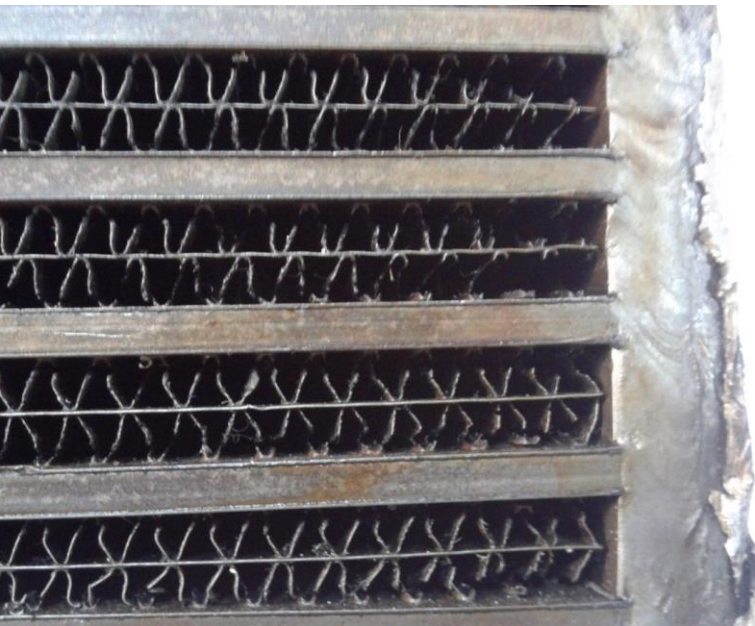
شکل ۸: عکس واقعی گرفته شده از هسته‌ی کارکرده‌ی مبدل حرارتی
