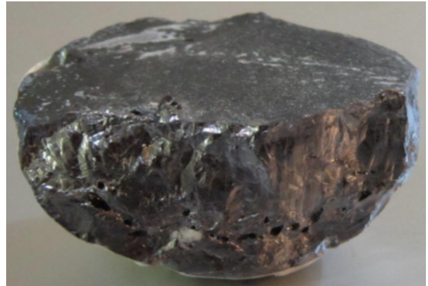
شکل ۴: تصویر شمش رشد داده شده که بلوردانه های آن به طور عمودی قرار گرفته اند .
